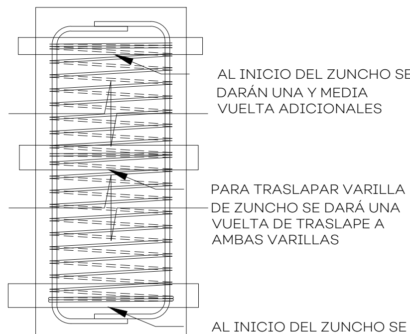
DETALLE DE REMATES Y TRASLAPES DE ZUNCHO ESC. 1:20 COTAS EN CM
